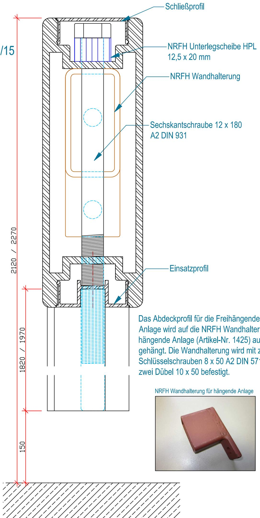
Das Abdeckprofil für die Freihängende Anlage wird auf die NRFH Wandhalterung für hängende Anlage (Artikel-Nr. 1425) aufgehängt. Die Wandhalterung wird mit zwei Schlüsselschrauben 8 x 50 A2 DIN 571 und zwei Dübel 10 x 50 befestigt.
